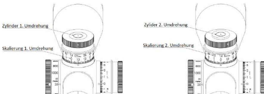
Abb. 7: Funktionsweise des Umdrehungsindikators
