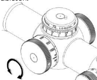
Abb. 4: Parallaxeausgleich einstellen
