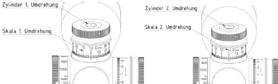
Abb. 8: Funktionsweise des Umdrehungsindikators
